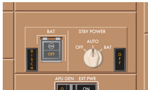
Рисунок 55. MAIN BATTERY SWITCH.
