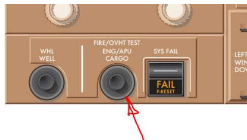
Рисунок 57. FIRE/OVHT TEST SWITCH.
