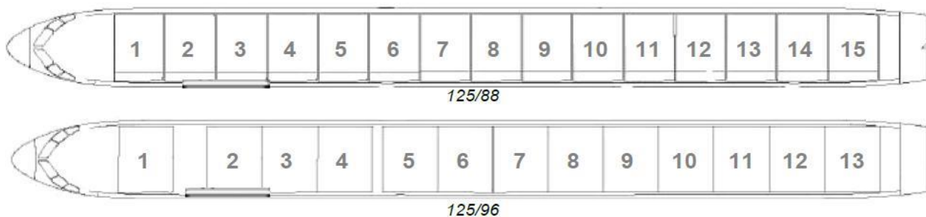
Рис.3-16. Расположение ULD на главной палубе Boeing 757 200 PCF
