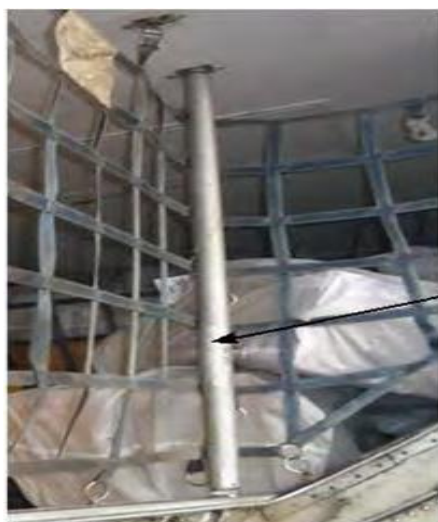
Рис. 3-23 Стойка для крепления дверной швартовочной сетки. BOEING 757 200 PCF
