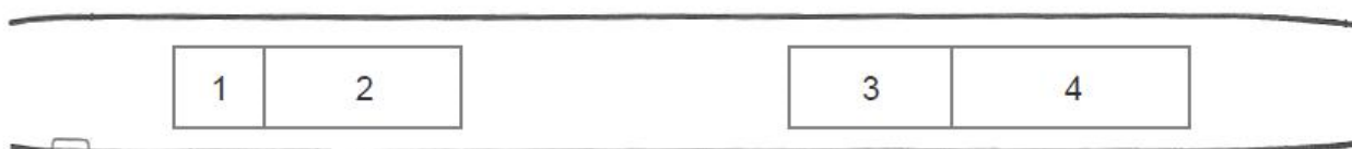
Рис. 3-17. Расположение отсеков нижней палубы Boeing 757 200 PCF
