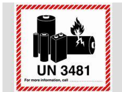
Рис. 4-45 Маркировочный знак Литий-ионные батареи, содержащейся в оборудовании.
