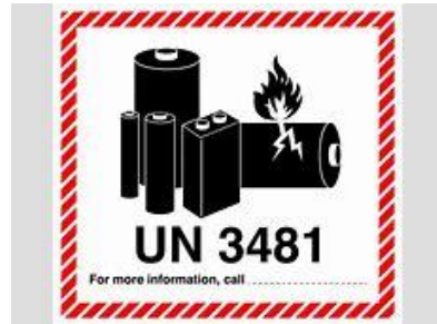
Рис. 4-45 Маркировочный знак Литий-ионные батареи, содержащейся в оборудовании.
