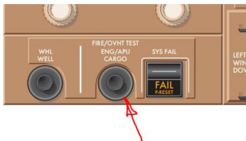
Рисунок 57. FIRE/OVHT TEST SWITCH.
